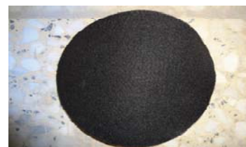
شکل (۳) - لایه ژئوکامپوزیت بریده شده به شکل مقطع قالب CBR
