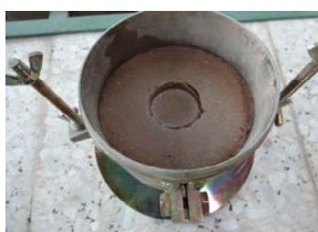
شکل (۶) - محل نفوذ سنبه در نمونه‌ی اشباع
